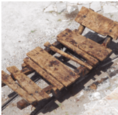
ARMÓN DE MADERA EMPLEADO PARA TRANSPORTAR EL AGAVE COCIDO HACIA EL ÁREA DE MOLIENDA. LAGUNA SECA, SAN LUIS POTOSÍ
