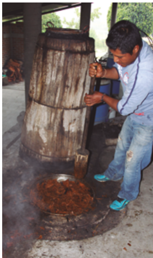
USO DEL ASENTADOR PARA COMPACTAR EL BAGAZO COCIDO Y TRITURADO EN LA OLLA DE DESTILACIÓN. ZUMPAHUACÁN, EDO. DE MÉXICO
