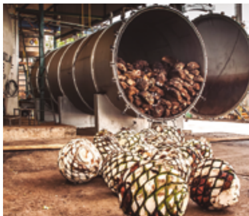
COCIMIENTO DE AGAVE EN AUTOCLAVE
