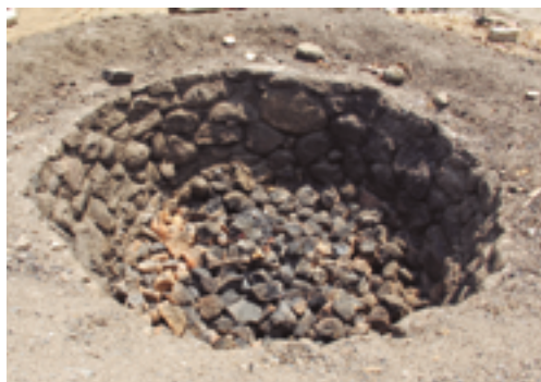
HORNO DE PISO ADEMACO CON CEMENTO Y ROCA VOLCÁNICA
