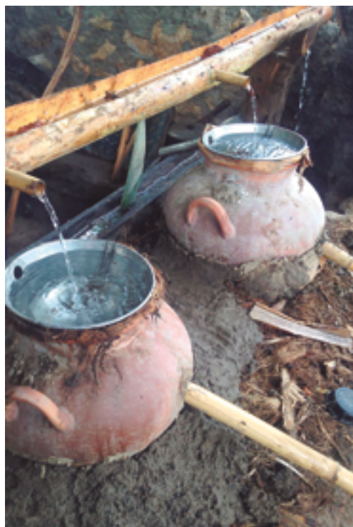
MEZCAL ANCESTRAL DESTILADO EN OLLAS DE BARRO
